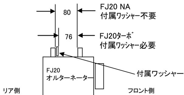
※エンジン側のブラケット寸法を現車で実測してください。
