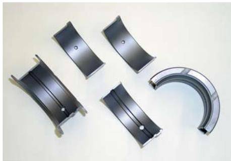
一般的なWPC処理とは違い、固体潤滑剤としてよく知られている二硫化モリブデン粉末を直接噴射することで、金属の表面組織内に固体潤滑剤が拡散浸透すると同時に表面に微細な凹凸を成型して油膜保持効果を高めます。このダブル効果によりフリクションを大きくし低減し、摩擦熱の発生を抑え焼き付き荷重を大幅に向上し、エンジンダメージを軽減できます。
