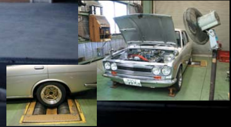
BOSCHシャーシーダイナモによるパーツの性能試験
