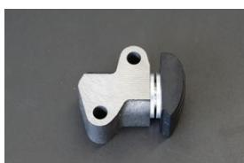
タイミングチェーンのたわみを抑えバルブタイミングを安定させるため重要なパーツです。バックストロークを制限するアルミワッシャーやパッキンが付属しています。
