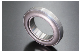
日産クラッチリリースベアリング 品番: 451S ¥4,370 ■適合 (標準) S20 G7 ※サイズ D=74 d=45 T=18 B=15 C=55
