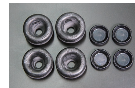
リヤホイールシリンダーカップキット 品番: SX46001 サイズ: 3/4 適応: TA22, TA27 (45.12~50.9) 価格: ¥5,000
