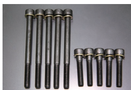
L6 カムホルダー強化ボルトSET ※多少長めの設定でネジ山を濡めづらい M8×100 締付：2.5kg/m(24.5N・m) M8×40 締付：2.2kg/m(21.5N・m) 価格： ¥2,250
