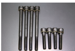
L4 カムホルダー強化ボルトSET ※多少長めの設定でネジ山を濡めづらい M8×100 締付：2.5kg/m(24.5N・m) M8×40 締付：2.2kg/m(21.5N・m) 価格： ¥1,800
