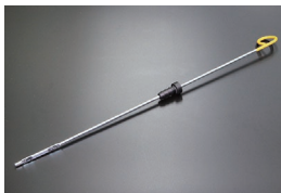
S130 オイルレベルゲージ ※上部からHまでの距離179mm HからLまで19mm 価格： ¥680 (2025.4.9更新)
