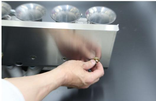
付属のボルトをヒートプレートの下面側から六角柱に向けてネジ止め。
