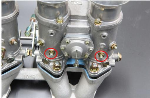
○印のベンチュリーストッパーボルトを利用して柱の取り付け。
