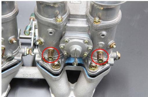
付属の六角柱をベンチュリーストッパーボルトに4本取り付けします。
