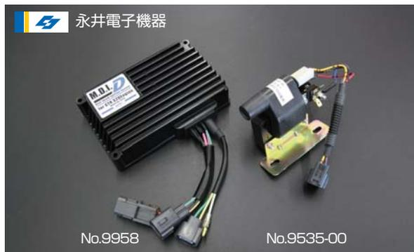
回転数に応じて2波、1波と点火スパーク数をコントロールするマルチプル点火方式とメインとサブの2系統の点火を加えた“デュアルスパークシステム”を新採用。さらに始動性の悪化、タコメーターの作動不良といった初期症状から始まる純正フルトラの不良に対応して、旧来SCAキットなど分散したアダプター類までワンボディに納めたGTR専用ユニット。純正のフルトラユニットに代わるSCA (信号アンブ) をMDI本体に内蔵し、MDIユニットの取り付けだけで完成してしまうGTRオーナー希望のMDIキットです。
