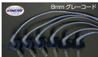
フルトラ、MDI-D対応に設計した亀有仕様の低抵抗プラグコードです。永井電子の標準品プラグコードの11kΩ抵抗に対し、亀有仕様はわずか3kΩの低抵抗を採用。それにより高電圧を無駄なくプラグに伝える事ができると共に、コイルやディスキャップ差込部の熱の発生を抑える事ができ、長期に渡り安定した火花供給を持続する事ができます。
