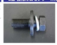
カムシャフトのノックピントラブルの殆どはセンターボルトの締め付け不良が原因です。強化ボルトの使用でノック ピンにかかる負荷を減らします。
