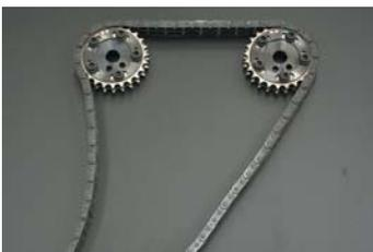
この強化チェーンは金属表面に5~10μmの比較的薄いリン酸マンガン系の不溶性皮膜を生成させ、素材表面に均一にムラなく浸透させたものです。これにより、4倍の耐摩耗性を実現！長期間に渡りチェーンの伸びによるVバルブタイミングの遅れを抑えられベストコンディションを維持します。また、チェーン駆動部によく発生する焼きやカジリにも強く、しなやかな動きをキープできフリクションロスの軽減にも役立ちます。
