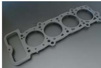
高いシール性を要求される燃焼室周りや水穴オイル穴の周囲にプレス加工によるビードを設けることにより面圧を確保するのがこのビードタイプヘッドガスケットです。そのレイアウトはビードの幅や高さによって適切に分布されており、チューニングエンジンに欠かすことのできないパーツです。
