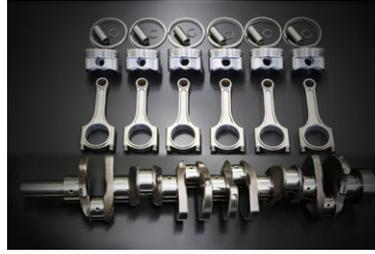
82.0φピストン+断面コンロッド+L28加工クランク=2.502cc
