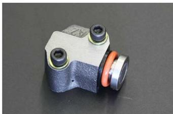
付属の4mm厚のダンパーリングと2mm厚のゴムワッシャーの組み合わせで、バックストロークを調整することができます。
