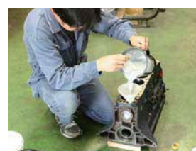
※ブロックフィラー作業順序 2 ブロックを水平に置いてジョーゴを使いリヤ側のウォータージャケットホールからブロックフィラーを流し込む。
