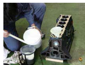
※ブロックフィラー作業順序 1 ブロックフィラーと硬化剤を1対1の割合で混ぜる。
