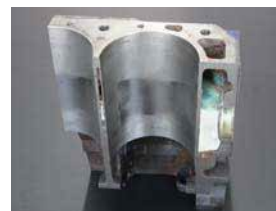
※ブロックフィラー作業順序 3 注入量は目的により異なります。ドラックレースは90～95mmから80～85mm、周回レースは90～95mmくらいが目安です。ブロックフィラーを入れた分だけ冷却水の容量が減り水温や油温に影響を与えるので目的に応じた量が必要です。
