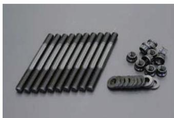
アメリカ ARP 社で設計されたスタッド式メインボルトです。充分な引っ張り強度を生かし、高回転におけるクランク振動を押さえ込み、4AG エンジンの高回転化を可能にします。また、スタッドボルトの採用によってメインボルトの締め付け力増大によるハウジング変形を最少に抑えられ、メタルクリアランスへの悪影響を軽減します。
