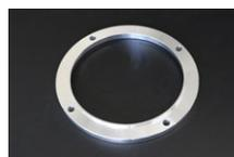
L型車のファンはオフセットに種類があります。エンジン側に寄っているタイプのファンでは、ファンがダンパープーリーのボルトに干渉する恐れがあります。このスペーサーはカップリングとファンの間に挟み込むことで羽の部分だけを前に8mmオフセットする事ができ干渉を防ぐことができます。
