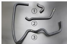
経年劣化により、ひび割れから水漏れに進行しやすいゴム製品のため定期的な点検と交換が必要。
