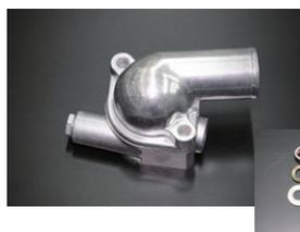
水回りパーツのなかで、最も腐食しやすく痛みやすいサーモハウジングとサーモカバーを復刻。
