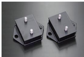
エンジンの振動を吸収するための重要なパーツ。ゴムの劣化やヒビなどが発生したら交換が必要。
