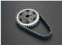
この強化チェーンは金属表面に5~10μの比較的薄いリン酸マンガン系の不溶性皮膜を生成させ、素材表面に均一にムラなく浸透させたものです。これにより、4倍の耐摩耗性を実現！長期間に渡りチェーンの伸びによるバルブタイミングの遅れを抑えられベストコンディションを維持します。また、チェーン摺動部によく発生する焼きやカジリにも強く、しなやかな動きをキープでき
