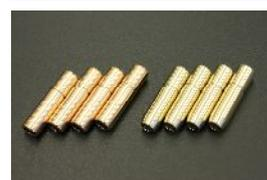
バルブガイドに要求される耐摩耗性、熱伝導性、耐焼付き性はIN,EXHの特性に応じた2つの材質の採用と、精密機械加工による内外径仕上によって達成されました。これによりバルブとのクリアランスを最少に抑えられるため、バルブの正確な動きが改善され、高出力高回転化を可能といたします。
