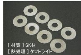
バルブスプリングの取り付け長は、性能向上の上で重要なポイント！シートカットで突き出しが伸びたり、バルブスプリングのヘタリによる荷重低下を段付きシートの下に敷く事で緩くなった荷重を補う事ができます。
