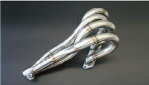
完全等長であることは当然のこと、2TGのエンジン特性を無駄なく引き出すために計算されたパイプ音長と集合部形状がこのタコ足の特徴です。4-1集合部の4方管内には、機械加工により高精度に削り出した4角垂を中央部に設置しました。それによって排気干渉を防ぎ中高回転域で高トルク高出力を最大限に引き出し2TGのポテンシャルをフルに発揮できます。
