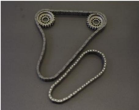
この強化チェーンは金属表面に5~10 $\mu$ の比較的薄いリン酸マンガン系の不溶性皮膜を生成させ、素材表面に均一にムラなく浸透させたものです。これにより、4倍の耐摩耗性を実現！長期間に渡りチェーンの伸びによるバルブタイミングの遅れを抑えられベストコンディションを維持します。また、チェーン摺動部によく発生する焼きやカジリにも強く、しなやかな動きをキープできフリクションロスの軽減にも役立ちます。
